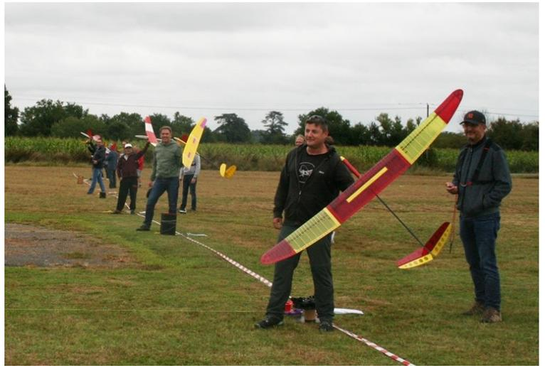
Les modèles sont mis en altitude par un sandow de 15m étiré jusqu'à 45m associé à un fil nylon de 100m qui les propulse à environ 90m de haut
